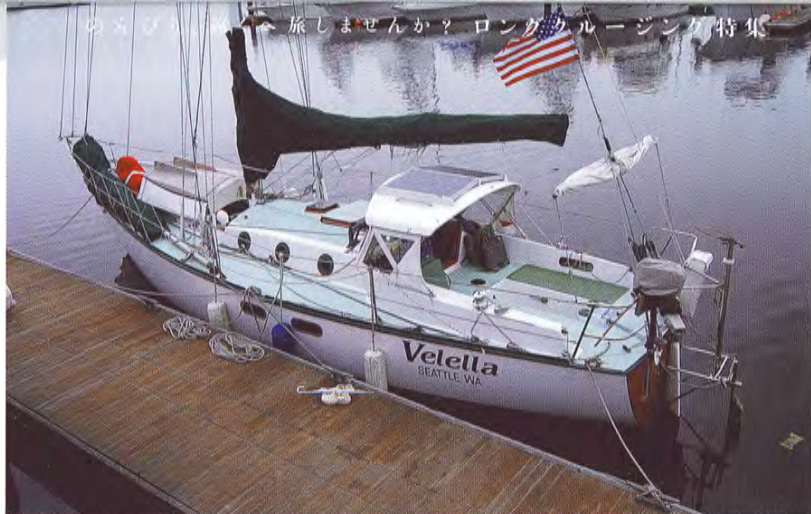
アメリカ人デザイナー、トム・ウィリー設計の31ftスloop艇〈ベレーラ〉。フィンキール、スケグ付きのアウトボートラダー仕様で、重量は4.5トン
